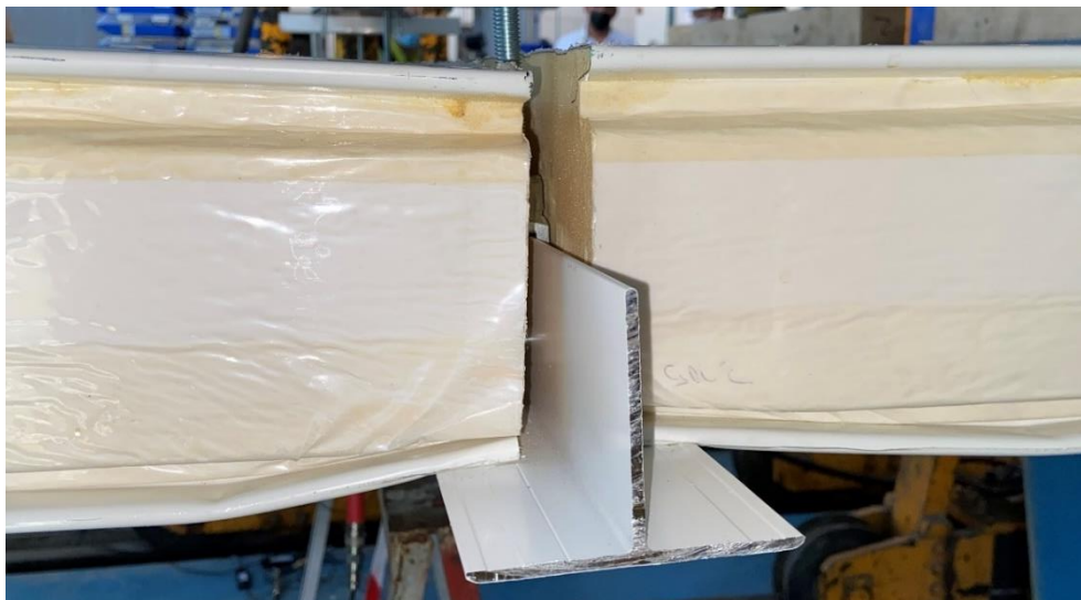
Photographie 4 : Ecrasement des panneaux sandwich après essai
