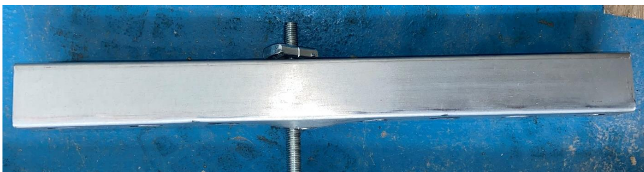
Photographie 7 : Fixation de levage centrale après essai (déformation au niveau de la suspente)
