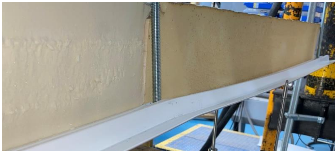
Photographie 9 : Déformée persistante au centre du profilé de supportage après essai (vue de profil)
