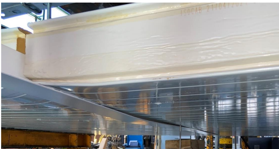
Photographie 5 : Déformation du profilé en fin d'essai
